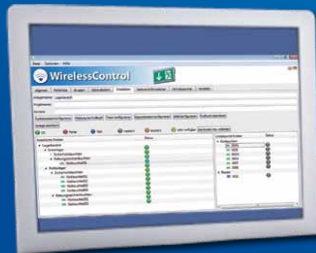
Jede im System angemeldete Leuchte erscheint übersichtlich mit ihrem aktuellen Status in einer Liste.
